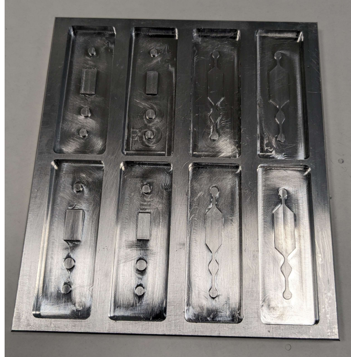
Figura 52. Molde para la fabricación de piezas de PDMS.
