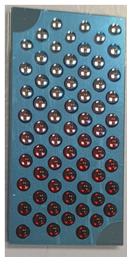
Figura 107. Imagen de un kit de diagnóstico en el que se están incubando diferentes concentraciones de AuNPs durante 4 horas, no existe evaporación.
