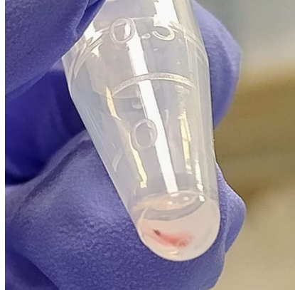
Figura 121. Nanopartículas aglomeradas durante una centrifugación.
