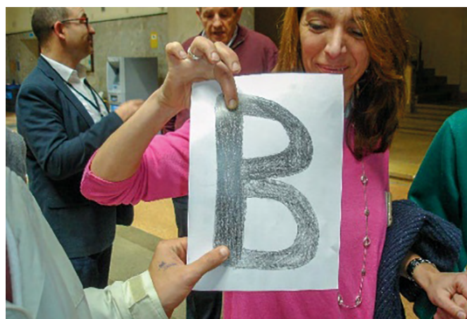
Fig. 2. Experiencia para la determinación del carácter conductor en trazos de lápices de tipo H y de tipo B.
