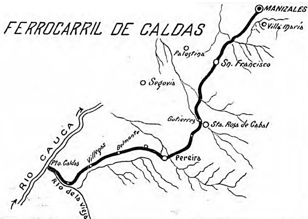
Figura 169. "Ferrocarril de Caldas". Empresario: el Departamento de Caldas. Anchura entre rieles: 0.914 metros. Peso de los rieles: 27 kilos por metro lineal. Pendiente máxima: 3% compensada en las curvas. Radio mínimo de curva: 78 metros." (Monsalve, 1927, pág. 836). La estación final en Puerto Caldas está localizada en frente de la estación de Cartago, Valle del Cauca, donde se construyó un puente ferroviario que comunicaba ambos puntos a lado y lado del río Cauca. No aparece en el gráfico la conexión entre Pereira y Armenia, que fue de las últimas líneas en construirse.
