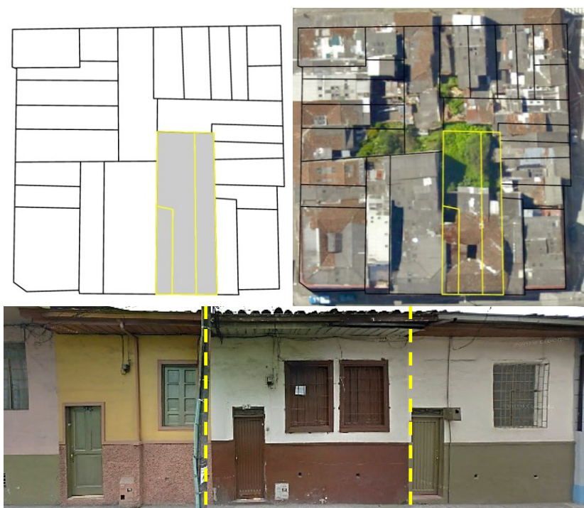
Figura 130. Vivienda de patio central de tipología "O", (Carrera 25 nº 28-30/28-26/28-24, subdivida en tres predios a lo largo de la casa original, cada uno con fachada sobre la Carrera 25. Se conserva la cubierta original con el alero de fachada. Fuente: elaboración propia con información tomada de Google Maps y el Geoportál de la Alcaldía de Manizales.
