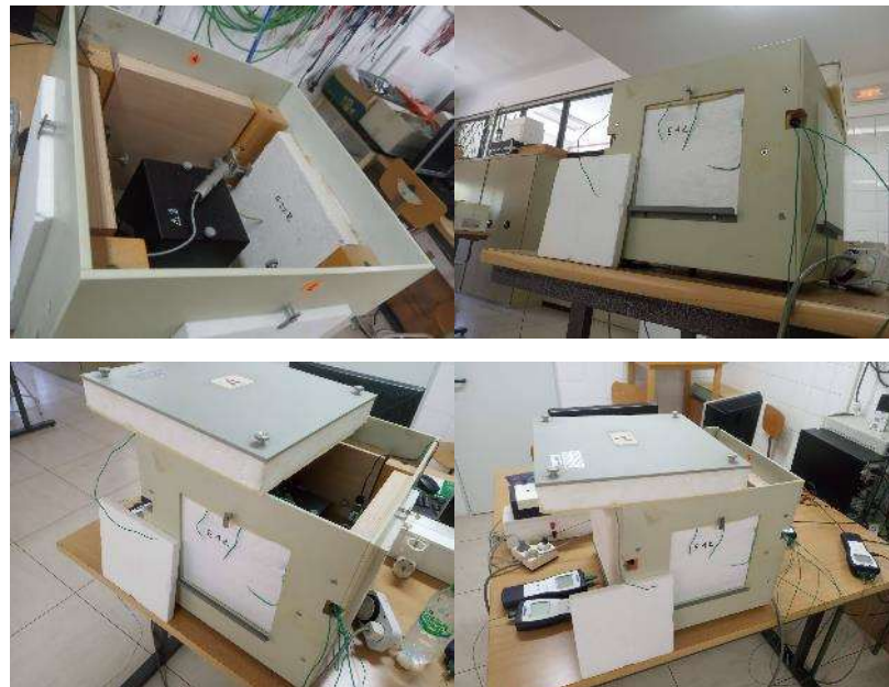
Imagen 22: Ensayo de caja térmica (Elaboración propia).
