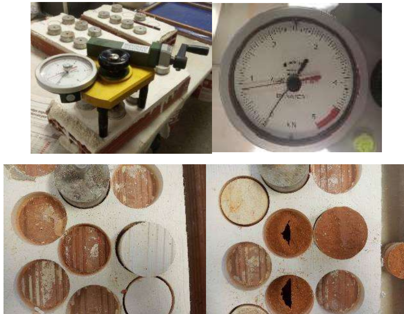
Imagen 21: Máquina extractora de discos. (Elaboración propia)
