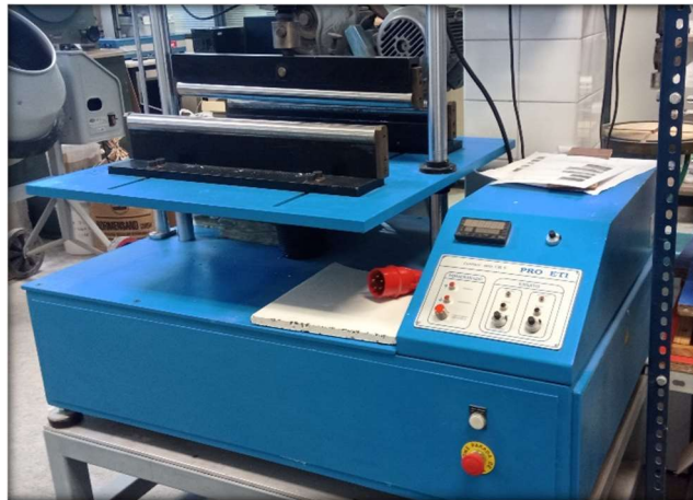
Imagen 25: Dispositivo de ensayo a flexión de placas (Elaboración propia).
