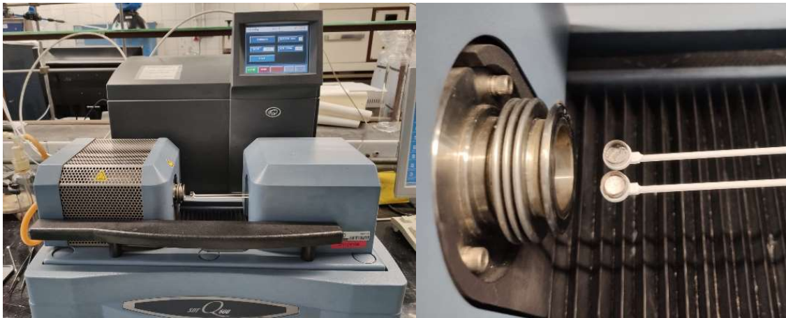
Imagen 13: Análisis térmico gravimétrico. Equipo (izquierda) y brazos de termobalanza (derecha).
