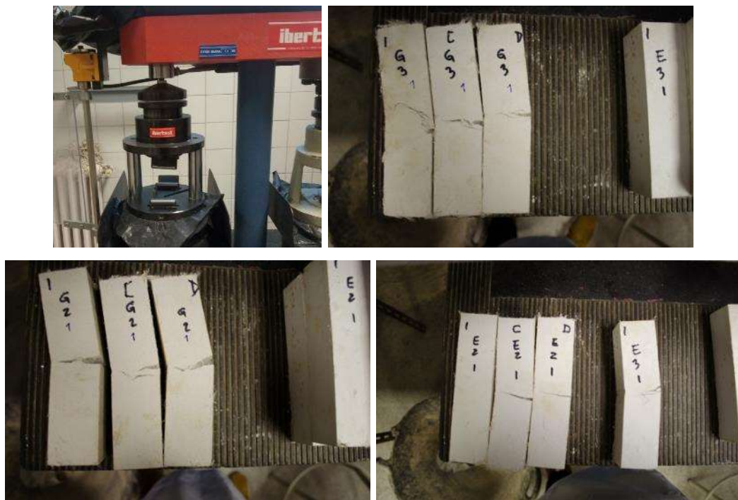
Imagen 19: Dispositivo de ensayo a flexión. (Elaboración propia)
