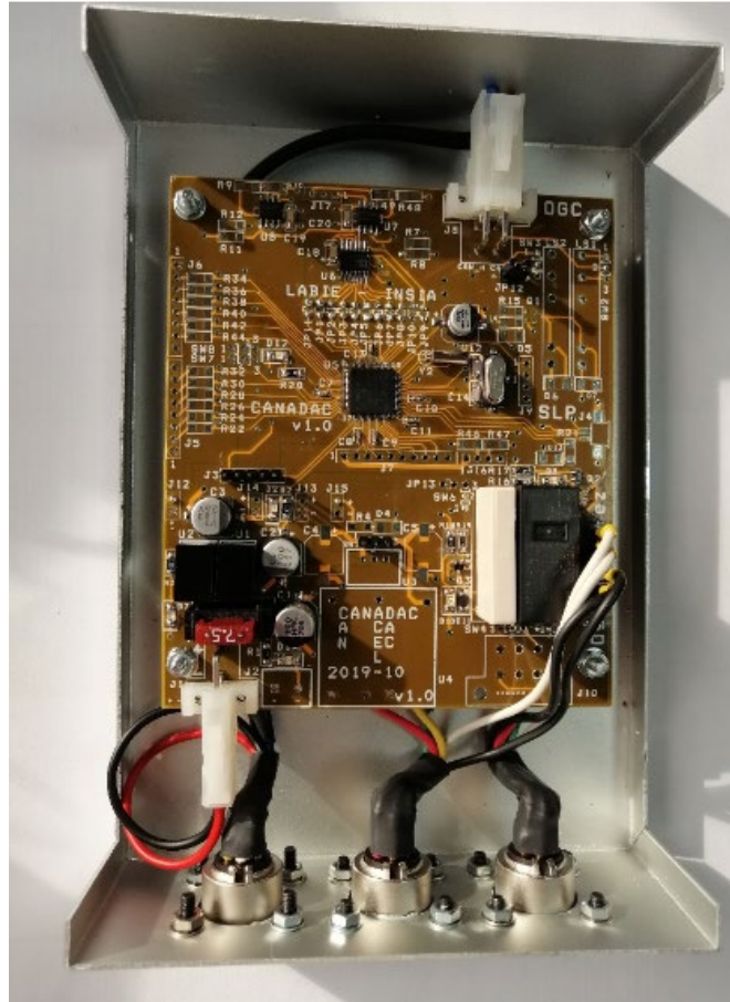
Ilustración 6: Placa electrónica para el control del acelerador CANADAC
