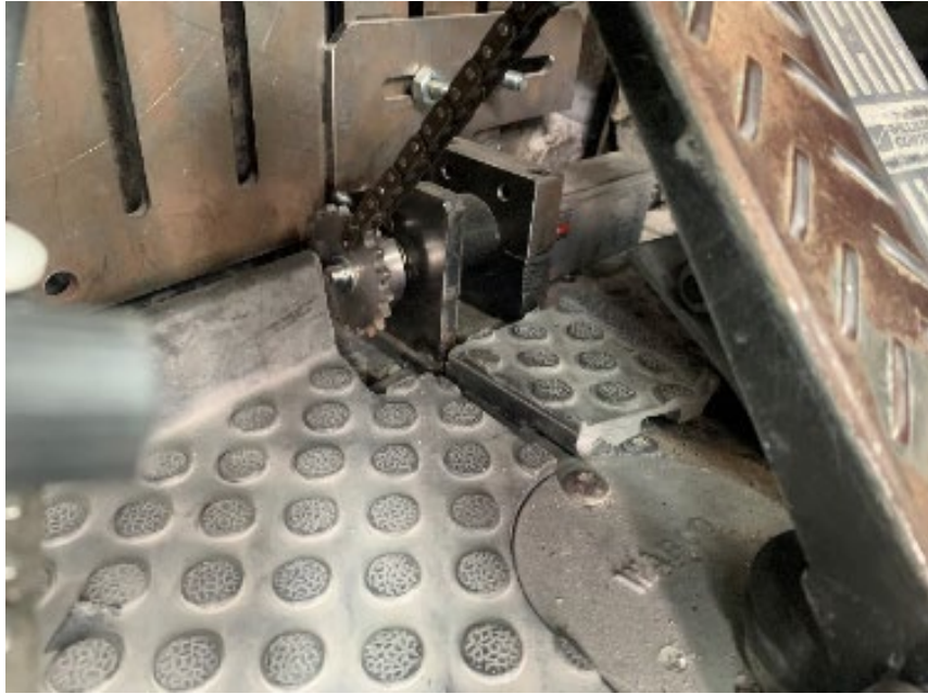
Ilustración 9: Detalle de la automatización del pedal del freno
