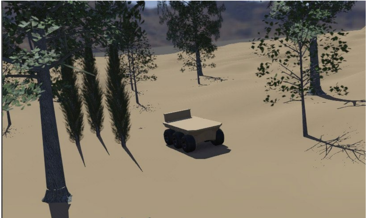
Ilustración 46: MUTT simulado en Webots realizando una ruta en autónomo entre árboles
