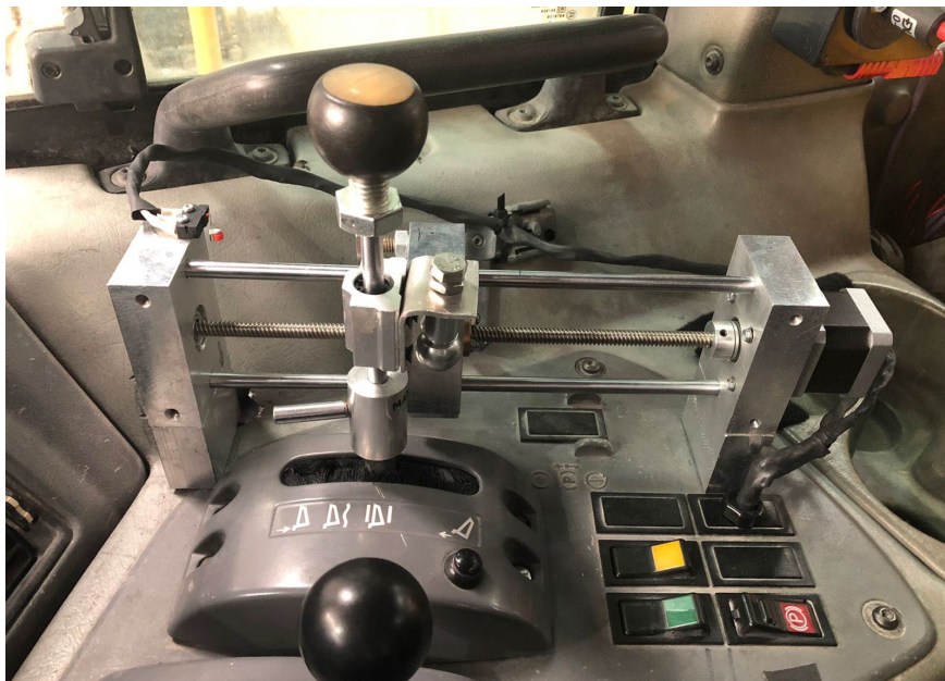
Ilustración 11: Dispositivo para el control del movimiento del volquete
