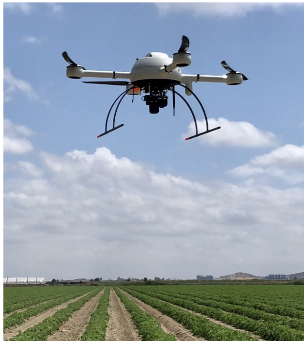
Figura 2.3: Vuelo del UAV md4-1000 equipado con un sensor RGB Sony ILCE-6300L sobre un cultivo de tomate en estado fenológico BBCH50.
