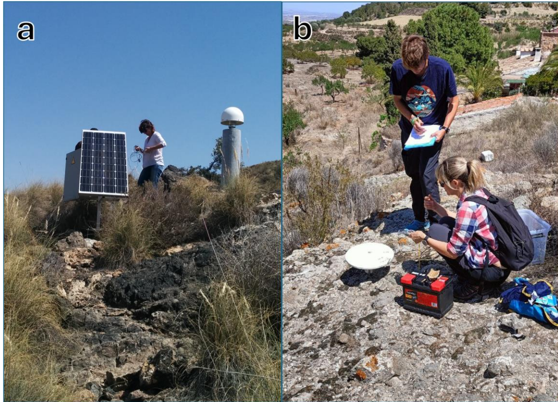
Figura 2.20: Campañas GNSS en las Béticas Orientales: (a) Mantenimiento de una estación GNSS permanente; (b) Medición de un punto de campaña.
