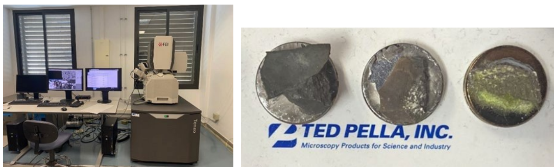
Figura 32. Izquierda: equipo SEM-FEI TENE0 para la realización de las muestras. Derecha: muestras metalizadas para su análisis.
