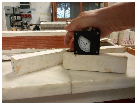
Figura 37. Determinación de la dureza superficial SHORE C
