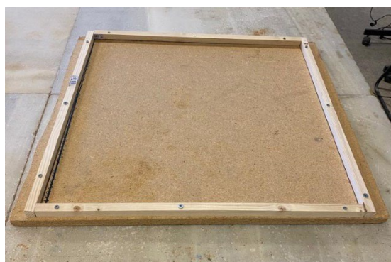
Figura 51: Molde para la ejecución de placas de techo en laboratorio.
