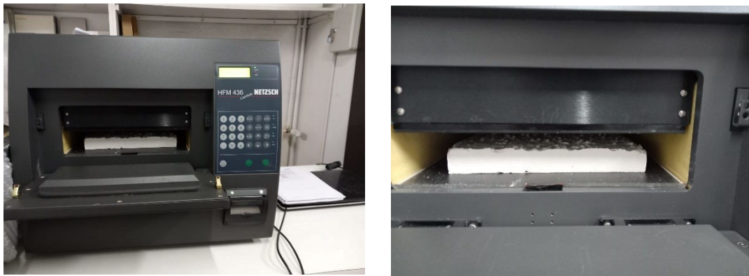
Figura 47. Equipo de medición de conductividad térmica. (HFM 436)
