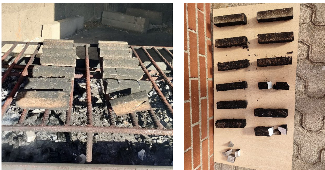
Figura 72: Estado de las probetas después del ensayo a fuego directo.
