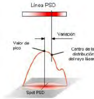
Figura 4.1 Lectura de coordenadas con sensor PSD. Fuente: [4]
