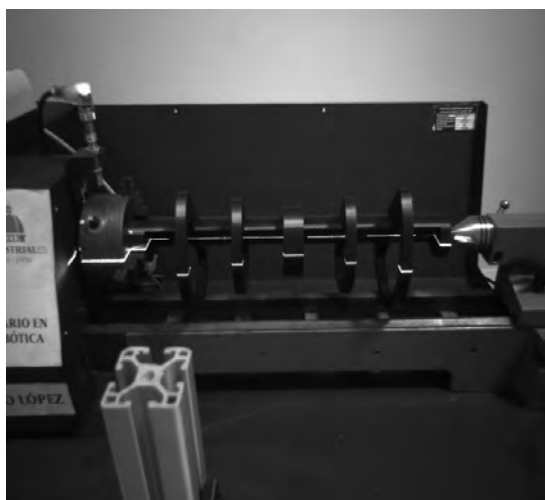
(c) Comprobación del eje de giro: -45 grados de inclinación
