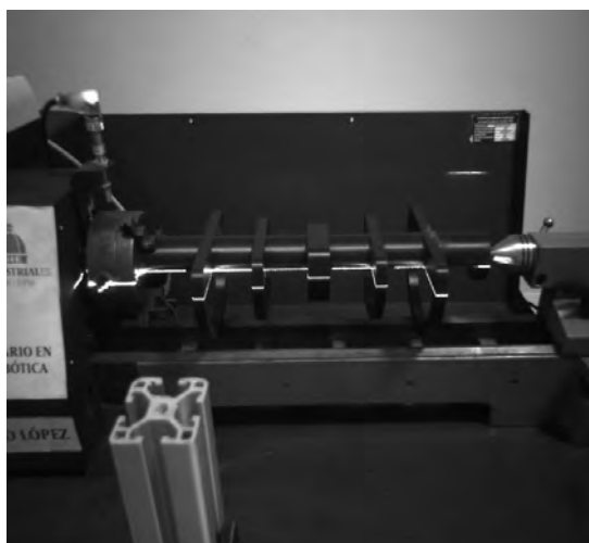
(e) Comprobación del eje de giro: -90 grados de inclinación
