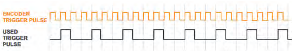
Figura 3.16 División de pulsos de encoder para la adquisición de imágenes. Fuente: www.photonfocus.com
