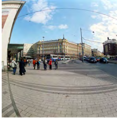
Figura 4.18 Ejemplo de distorsión radial. Fuente: www.wikipedia.com
