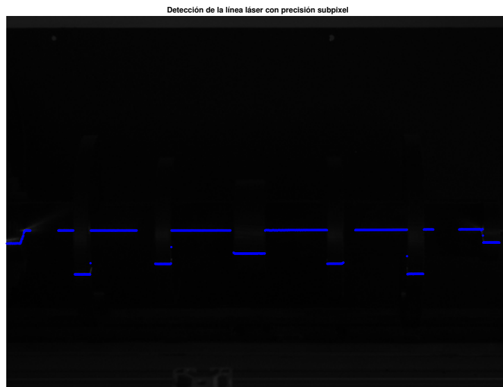
Figura 5.50 Imagen de ejemplo de la extracción de la línea láser con precisión subpixel
