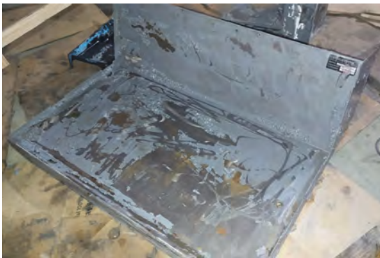
(a) Restauración del chasis: lijado
