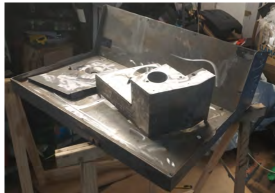
(b) Restauración del chasis: resultado del lijado
