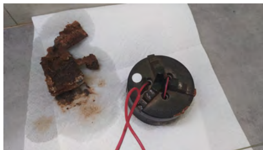
(c) Resultado tras finalizar la electrólisis en la mordaza
