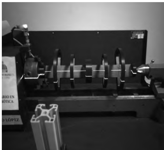
(b) Comprobación del eje de giro: 45 grados de inclinación
