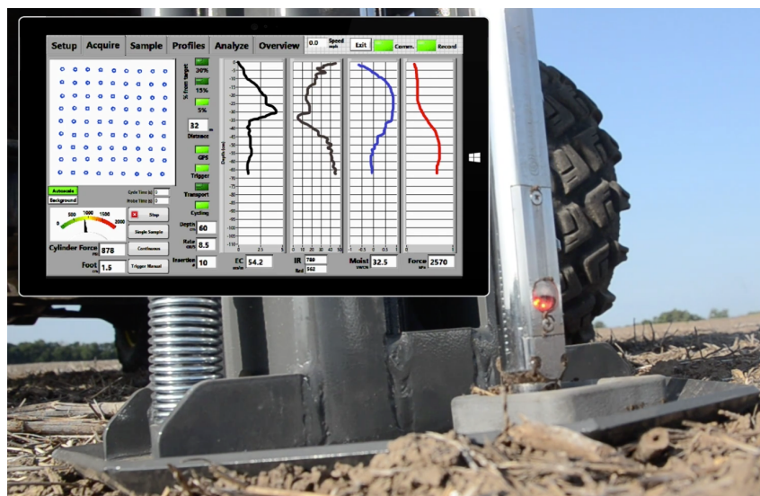
Figura 3.5. Radar de penetración terrestre captura digitalmente propiedades de suelos de múltiples capas con precisión (Veris CoreScan™)
