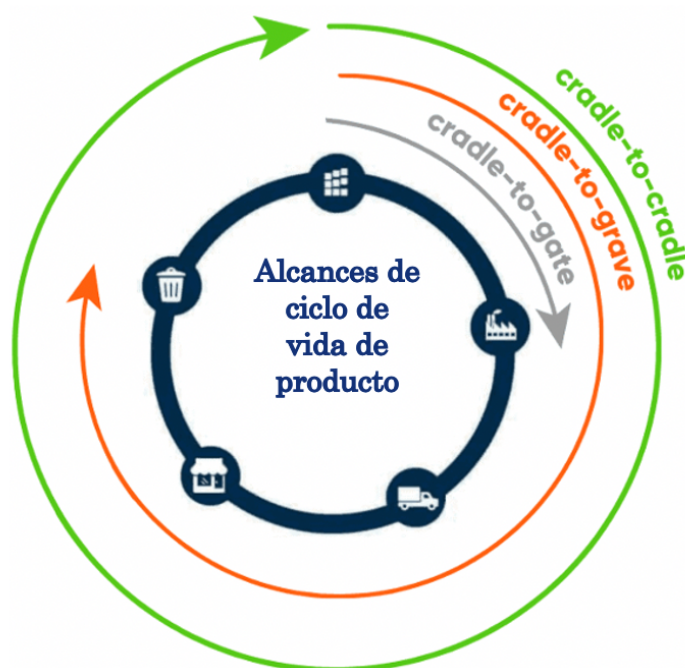
Figura 3.21. Modelos de ciclo de vida en ACV (adaptado de Ecochain, 2024)
