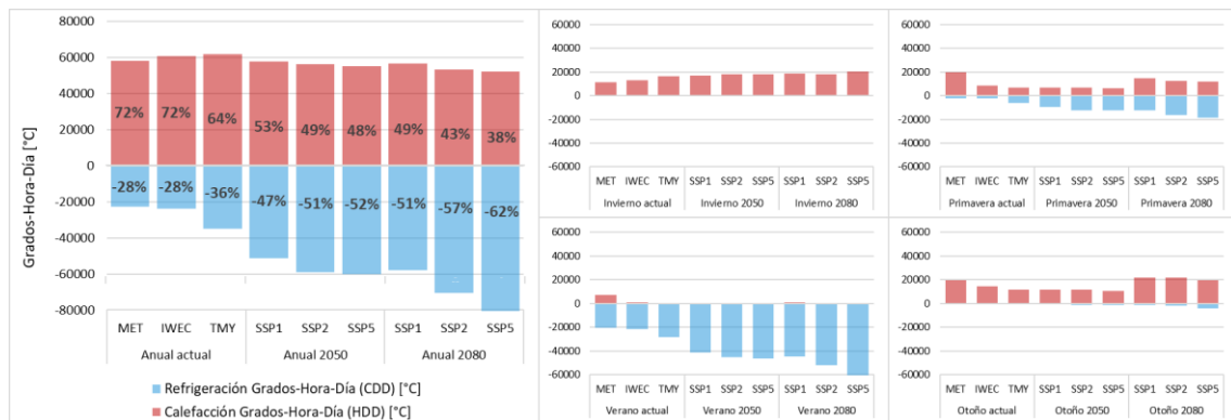
Figura 20. Valores de los grados-día-hora de calefacción (HDD) y refrigeración (CDD) para los archivos climáticos MET, IWECC, TMY y sus proyecciones SSP1-2.6, SSP2- 4.5, y SSP5-8.5 para los años 2050 y 2080.
