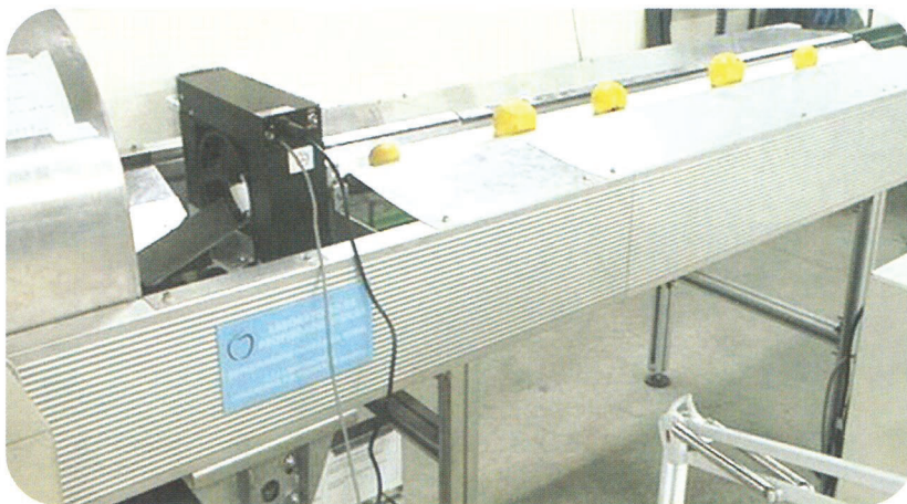
Figura 3. Vista general del anillo óptico (en negro) y el alineador o doble banda en V que lanza los frutos para que atraviesen el anillo. (.)
