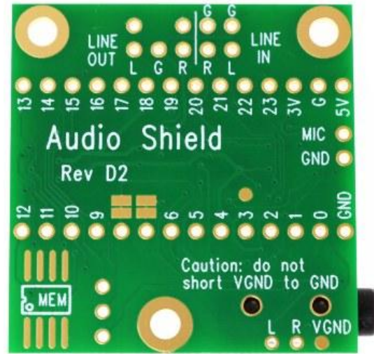
Figura 10: Esquema trasero de la placa de audio para Teensy® 4.0. [11]
