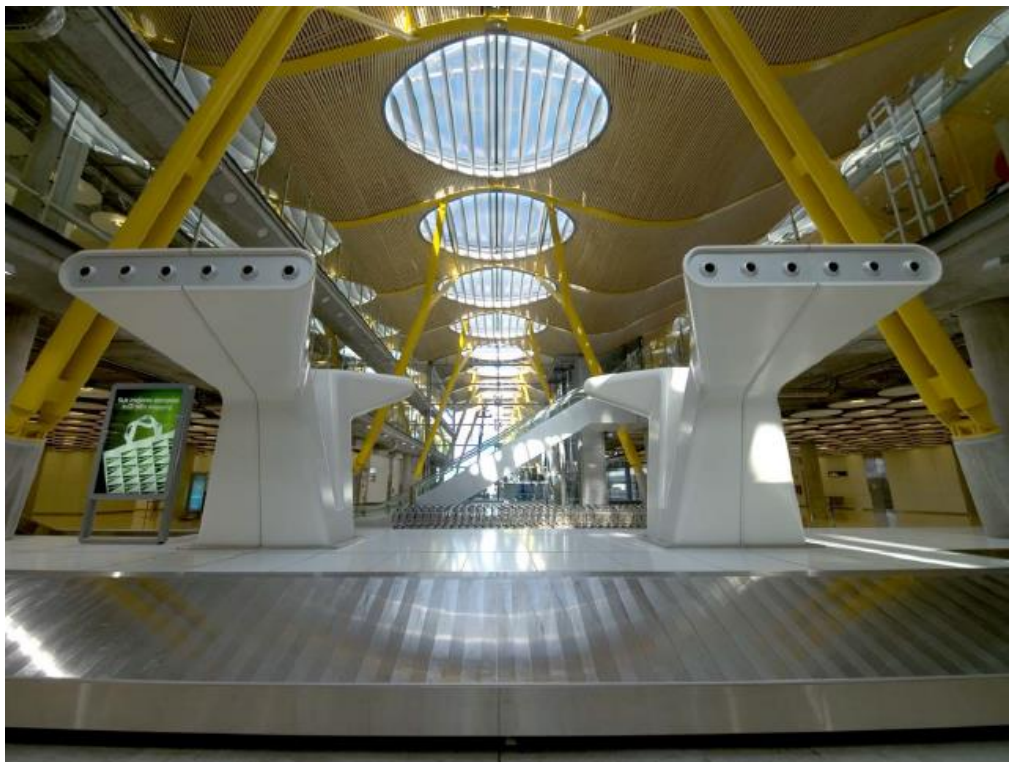
Ilustración 44. Claraboyas luz natural. Aprovechamiento niveles inferiores.
