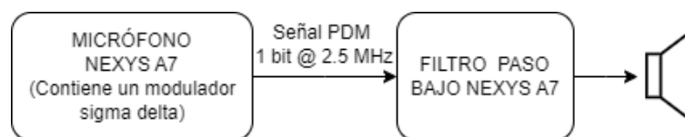
Figura 4.1. Circuito para la prueba del micrófono y la salida de audio.
