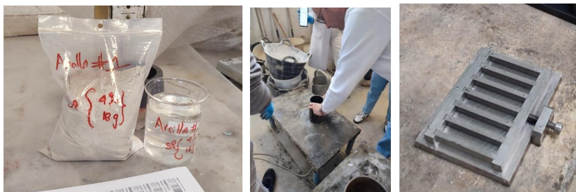
Figura 15. De izquierda a derecha, material dosificado para elaborar morteros y pastas, mesa vibratoria y moldes para pastas. (Fotografías propias).
