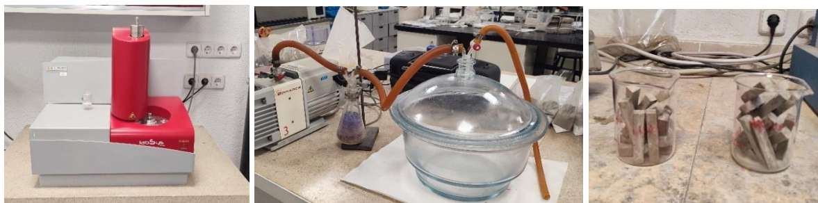
Figura 18. De izquierda a derecha, equipo LABSYS, de SETARAM Instrumentación, cámara de vacío, y probetas prismáticas de pastas (Fotografías propias).
