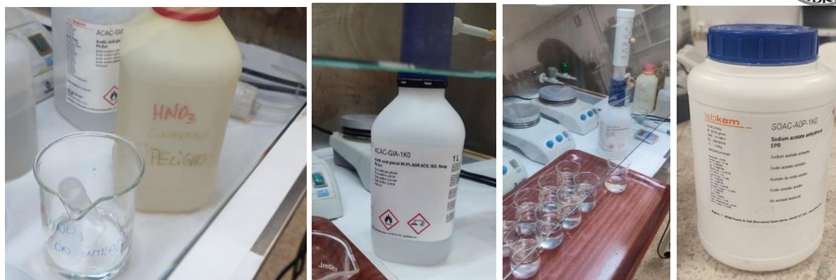
Figura 34 De izquierda a derecha, adición de 2ml de \text{HNO}_3 , adición de 20ml de Ácido Acético Y 0.50 gr de acetato de sodio. (Fotografías propias).
