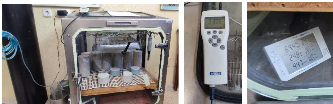
Figura 36. Cámara de carbonatación, dispositivo control de concentración de CO 2 , sensor de humedad, temperatura y probetas colocadas en la cámara de carbonatación. (Fotografías propias).
