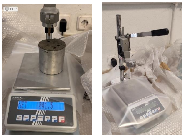
Figura 19. Equipo para ensayo de fraguado en morteros. (Fotografías propias).
