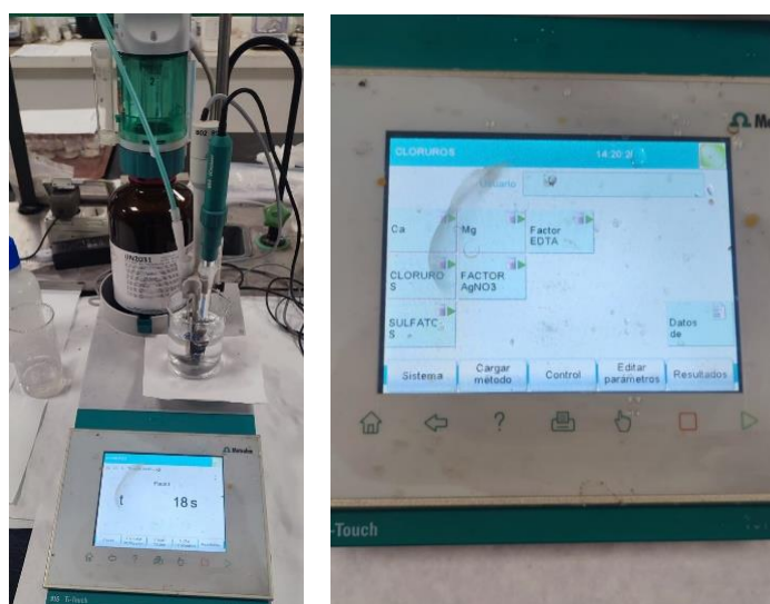
Figura 35 Equipo potenciométrico con solución de nitrato de plata para cuantificar concentraciones de cloruros. (Fotografías propias).
