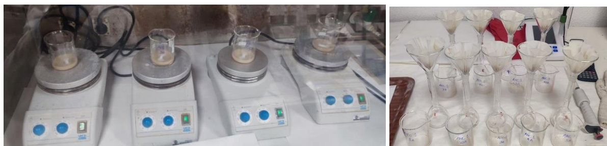
Figura 33 De izquierda a derecha, proceso de agitación mecánica, Matraces con embudos y filtros para filtrar la mezcla. (Fotografías propias).
