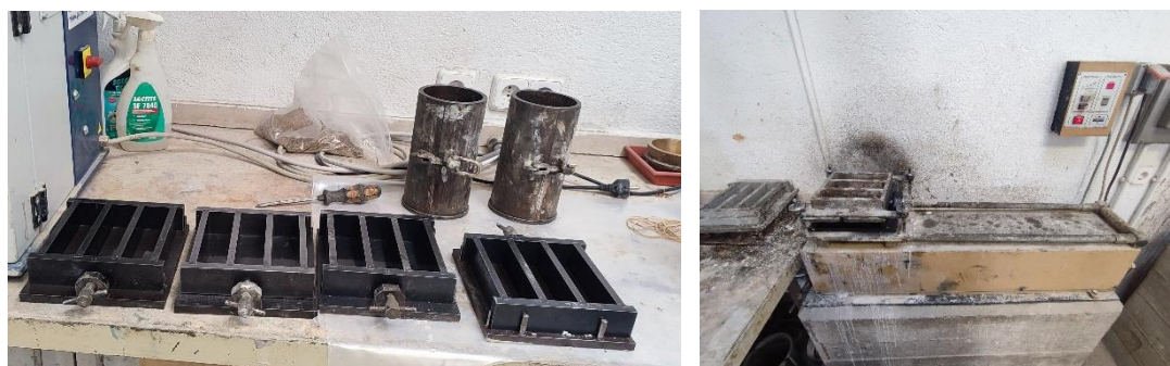
Figura 14. De izquierda de derecha, moldes para probetas prismáticas y cilíndricas para morteros; maquina compactadora por golpes. (Fotografías propias).
