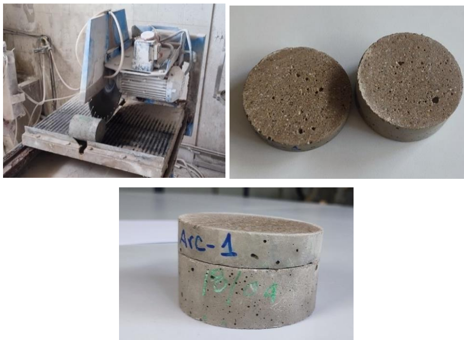
Figura 37. De izquierda a derecha, maquina cortadora de hormigón / morteros, probeta cortada en rebanadas. (Fotografías propias).
