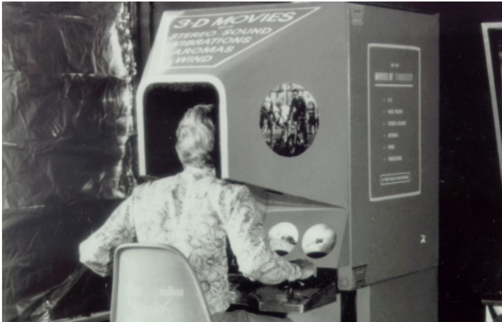
Figura 3: Máquina conocida como "Sensorama", el antecedente de la RV.
