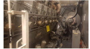
Figura 3.2.2. Uno de los motores diésel que propulsan la fragata
