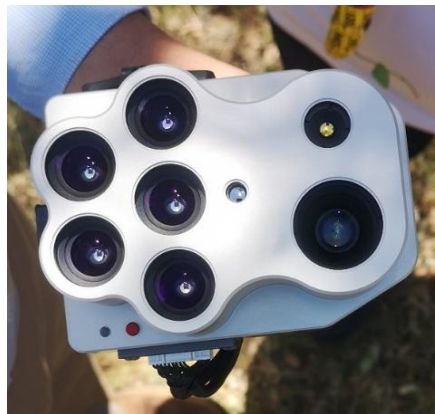
Figura 19. Cámara MicaSense RedEdge-MX: Multiespectral. Fuente. elaboración propia
