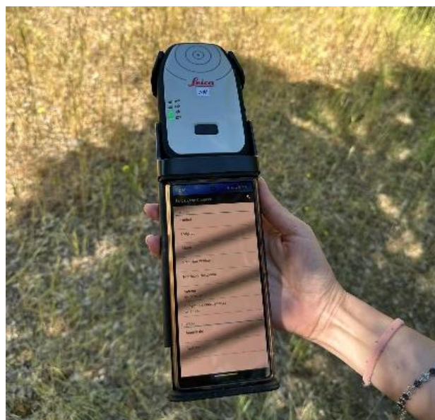
Figura 12. Antena GNSS inteligente compacta "Leica Zeno FLX100 plus". Fuente: elaboración propia
