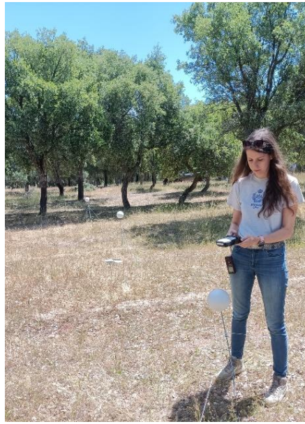
Figura 26. Recogida de datos para el inventario 20 de mayo de 2024 con la antena GNSS "Leica Zeno FLX100 plus"
