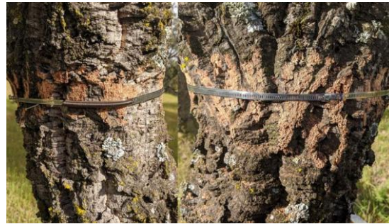
Figura 13. Detalle de los dendrómetros de banda instalados. A la izquierda se muestra el muelle y a la derecha la zona de medida. Fuente: Monitorización del crecimiento diametral del alcornoque diferenciando el crecimiento de la madera y del corcho (Sociedad Española de Ciencias Forestales).
