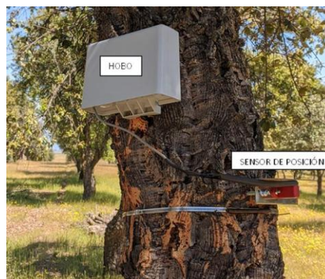
Figura 14. HOBO UX120-006M con sensor de posición. Fuente: Monitorización del crecimiento diametral del alcornoque diferenciando el crecimiento de la madera y del corcho (Sociedad Española de Ciencias Forestales).
