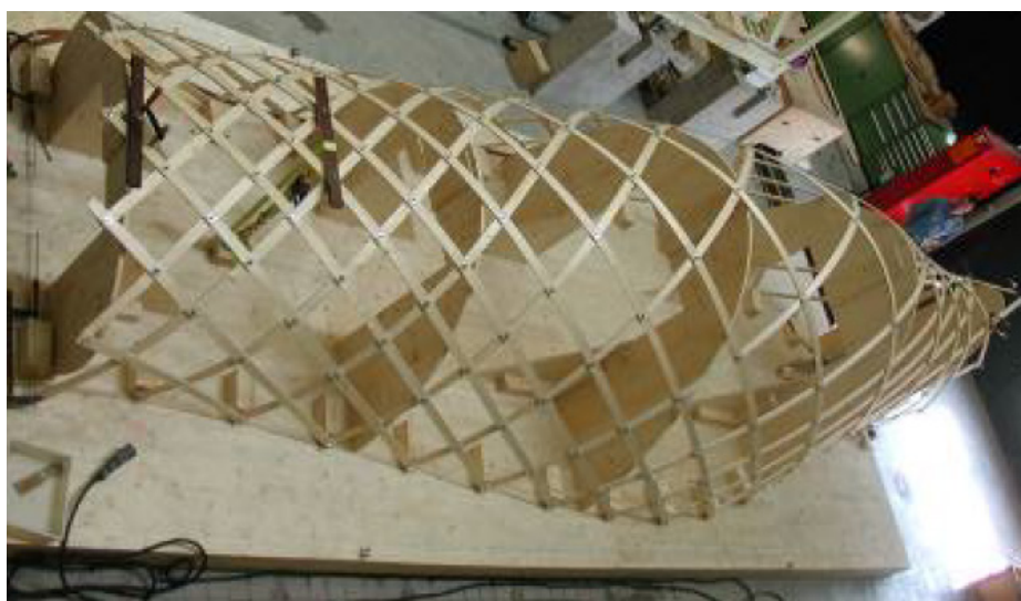
[Fig. 1.10] Prueba de carga de la estructura Geodesic Ribbed shell.
