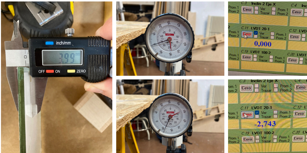
[Fig. 3.19] Medición de los vidrios mediante un calibre. (izq.)
