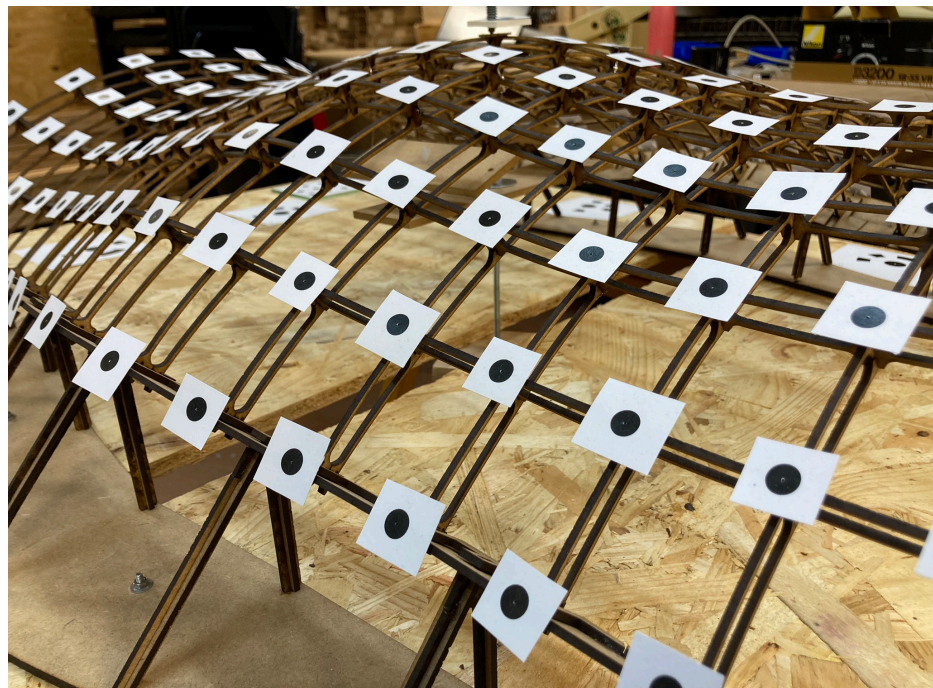
[Fig. 3.09] Dianas no codificadas sobre la estructura.
