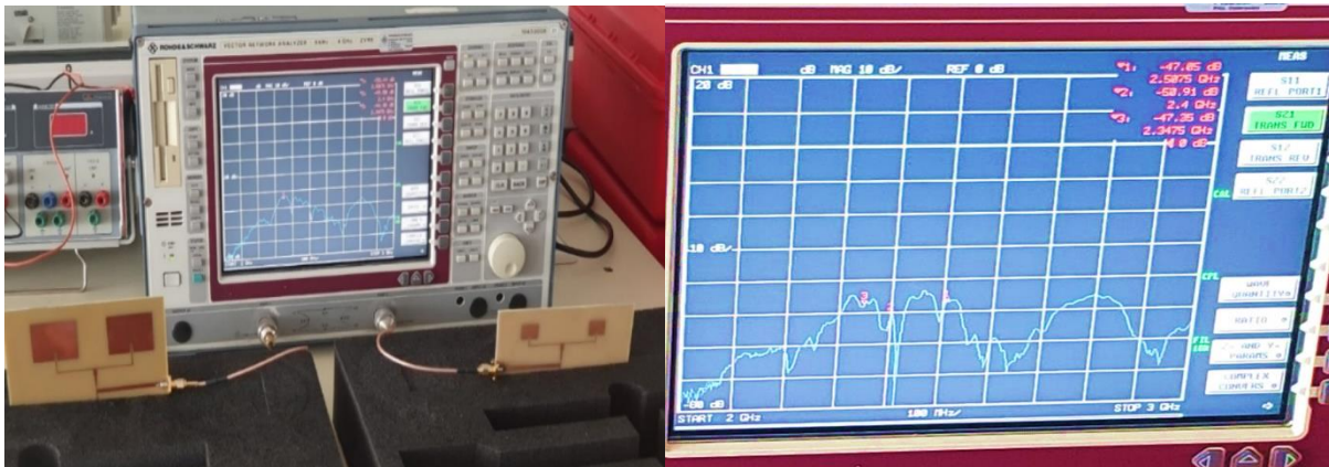
Figura 74. Antenas en vertical colocadas en paralelo
