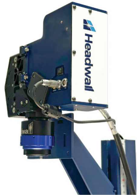
Figura 3.2. Cámara SWIR 640 fijada a la estructura móvil en el interior del cubo.
