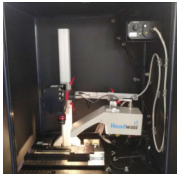
Figura 2.6. Distribución captura imagen hiperespectral [3].
