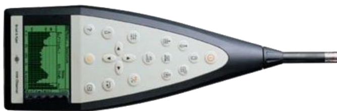
Figura 14. Sonómetro Brüel & Kjaer 2260
