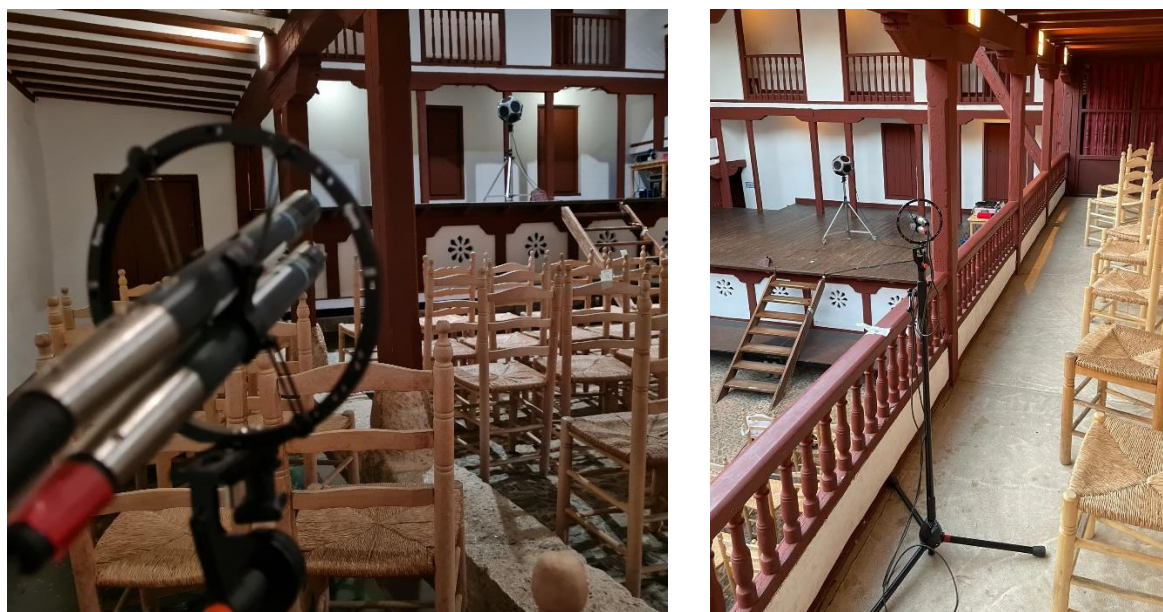
Figura 22. Izq. Micrófono M05 situado en el palco 5 (planta baja). Drcha. Micrófono M24 situado en el palco 16 (planta 1) (Producción propia)
