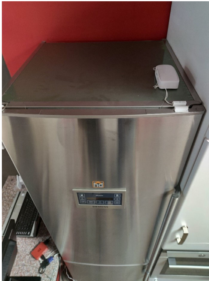
Figura 21: Instalación de sensor Open Close en nevera
