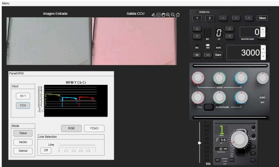
Figura 22: Interfaz de usuario de la aplicación al aplicar una ganancia de balance de blanco en la componente roja sobre la imagen “pared blanca”
