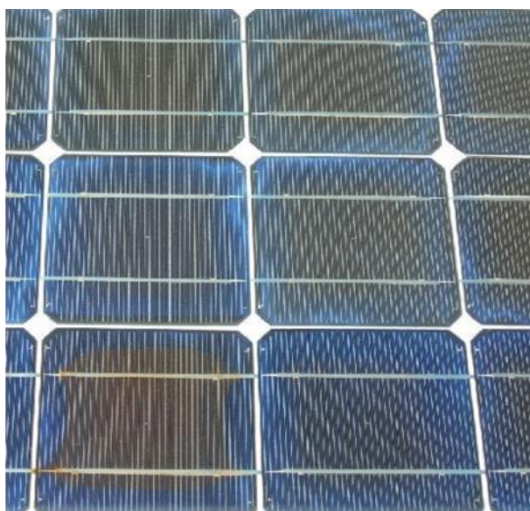
Figura 14. Decoloración del encapsulante en celdas de silicio
