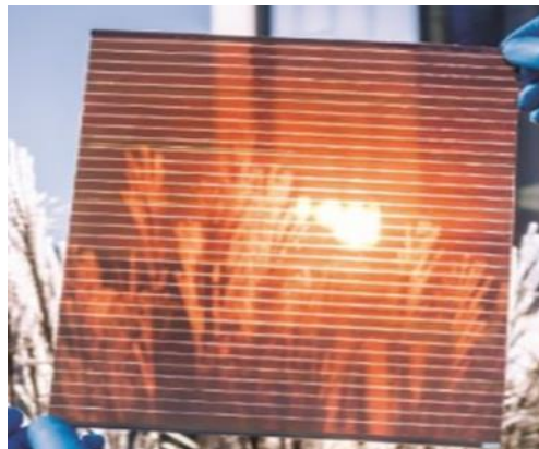
Figura 6. Célula de Perovskita [11]
