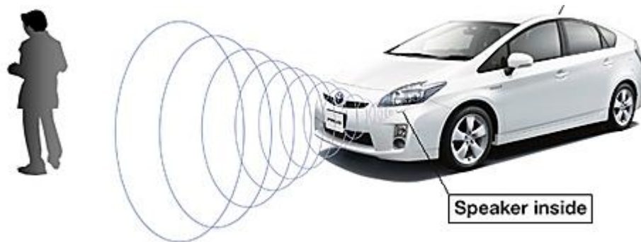
Figura 1. Representación del sistema acústico de advertencia instalado en el modelo Toyota Prius [7].
