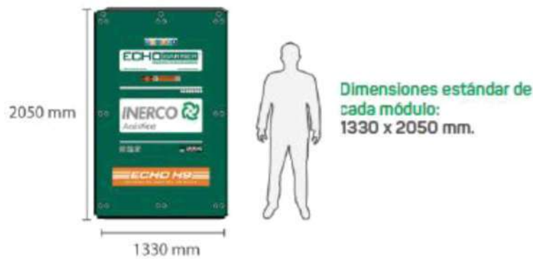
Ilustración 45 Medidas de la barrera Echo Barrier H9
