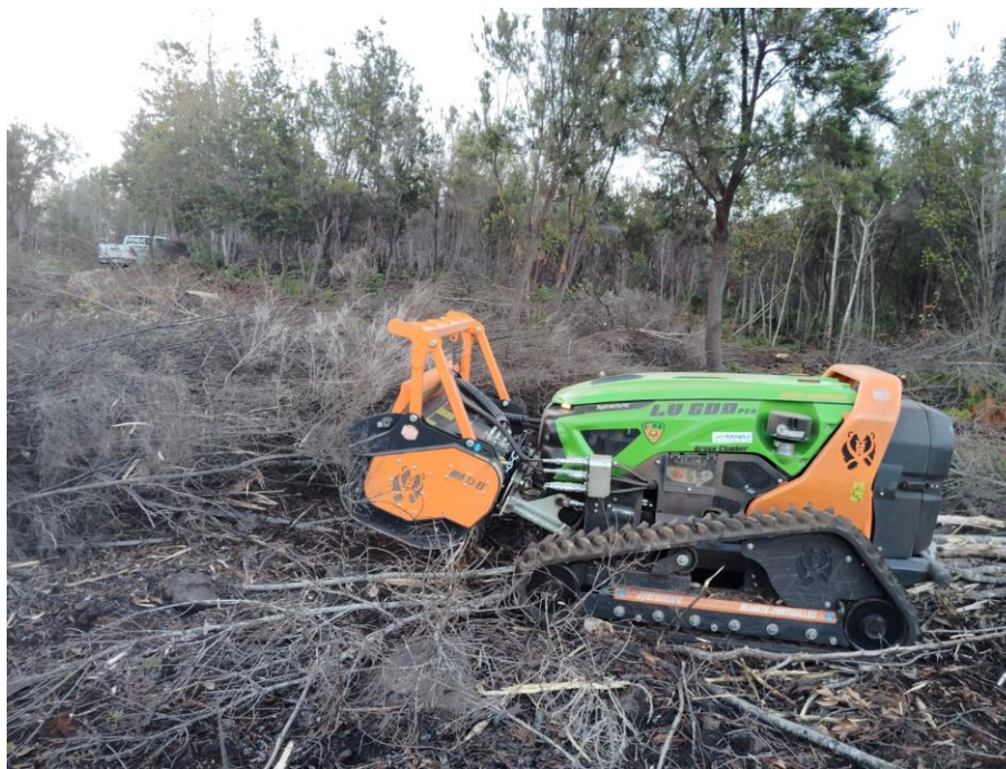
Imagen n.º 3. Ejemplo de triturado mecanizado sobre pedregosidad escasa y pendientes menores al 40%. Robot de astillado teledirigido (LV600) con apero de martillos. Elaboración propia.
