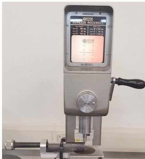
Figura 82 Detalle medición dureza Rockwell de la probeta Fuente: Elaboración Propia
