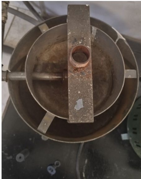
Figura 56 Equipo de templado Jominy, detalle del soporte de la probeta Fuente: Elaboración Propia
