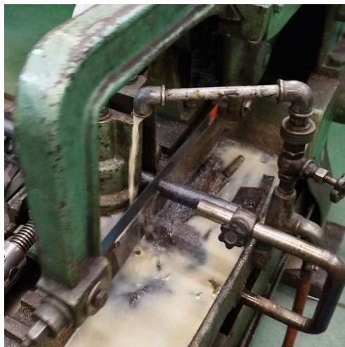
Figura 65 Corte de la materia prima con sierra de vaivén Fuente: Elaboración Propia
