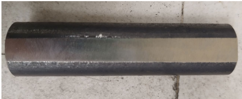
Figura 69 Detalle de los mecanizados antes del lijado y pulido Fuente: Elaboración Propia
