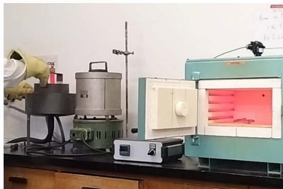
Figura 77 Colocación de la probeta en el equipo de templeado Jominy Fuente: Elaboración Propia
