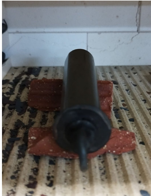
Figura 51 Colocación de la probeta en el horno Fuente: Elaboración Propia
