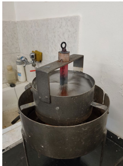
Figura 58 Equipo de templado Jominy, momento del temple Fuente: Elaboración Propia
