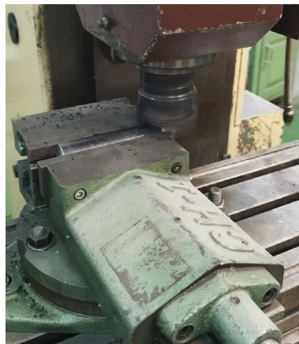
Figura 67 Mecanizado de los rebajes en fresa universal Fuente: Elaboración Propia
