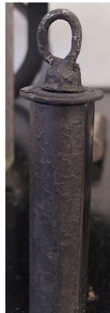
Figura 75 Probeta tras el montaje para templado Fuente: Elaboración Propia
