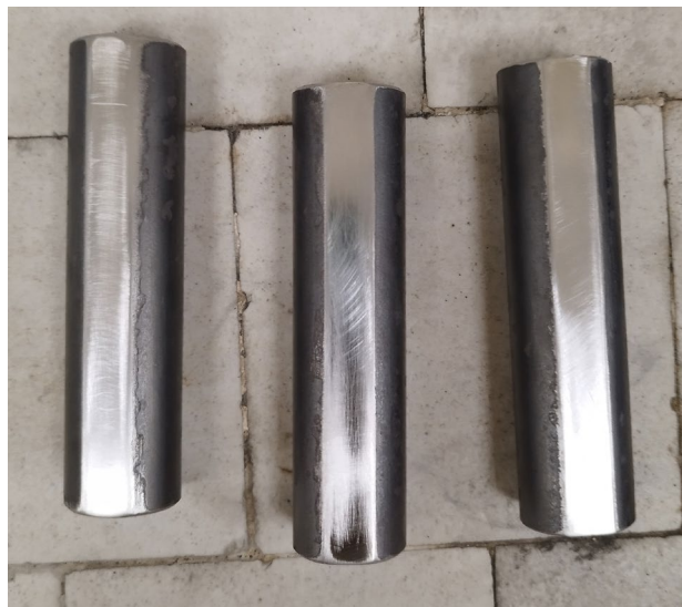
Figura 72 Detalle de las probetas tras el lijado de los rebajes Fuente: Elaboración Propia
