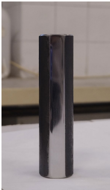
Figura 74 Detalle de la probeta tras el pulido a espejo Fuente: Elaboración Propia
