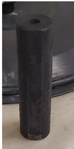
Figura 81 Detalle de la probeta tras el tratamiento térmico con la escoria Fuente: Elaboración Propia
