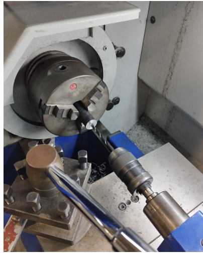
Figura 66 Procesado de la pieza en torno paralelo Fuente: Elaboración Propia
