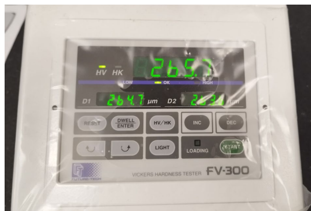
Figura 62 Equipo de medida dureza Vickers, detalle pantalla Fuente: Elaboración Propia
