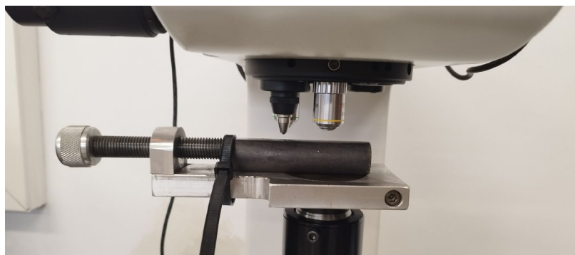
Figura 83 Detalle medición dureza Vickers de la probeta Fuente: Elaboración Propia
