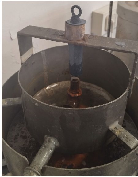
Figura 57 Equipo de templado Jominy, colocación de la probeta Fuente: Elaboración Propia
