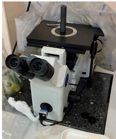
Figura 64 Microscopio ZEISS para toma de micrografías. Fuente: Elaboración Propia
