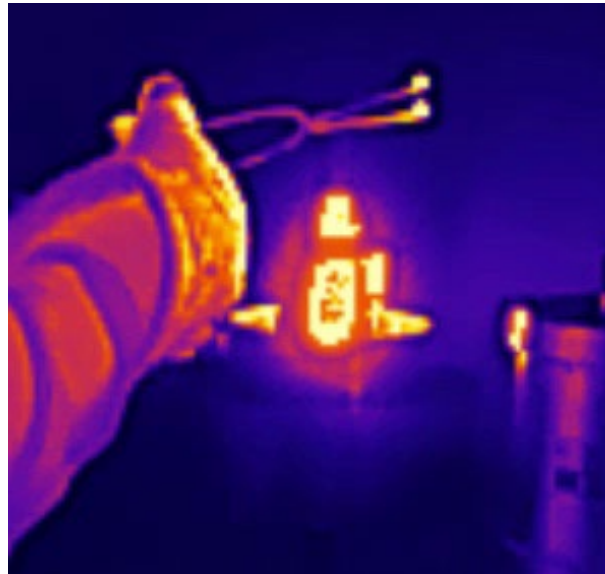
Figura 78 Imagen térmica de la colocación de la probeta en el equipo de templado Jominy Fuente: Elaboración Propia
