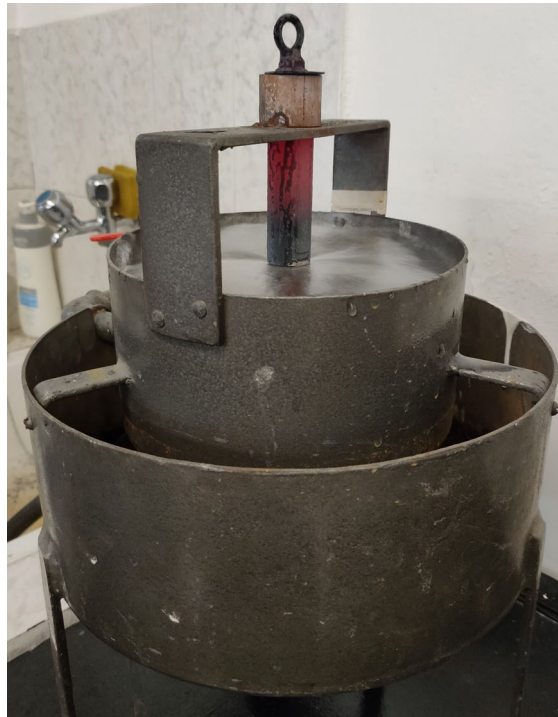
Figura 79 Probeta durante el proceso de templado en el equipo Jominy Fuente: Elaboración Propia
