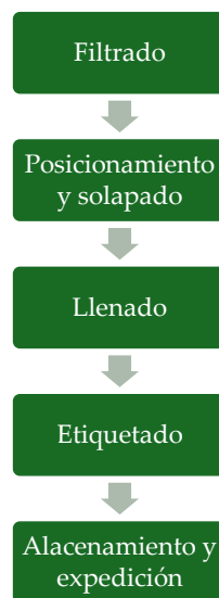
Ilustración 7. Diagrama de embotellado
