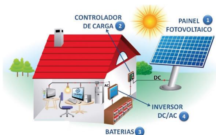
Figura 3-6: Instalación fotovoltaica aislada de la red [5]
