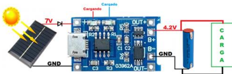
Figura 4-4: Montaje y conexión del módulo TP4056
