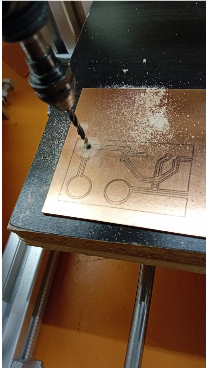
Ilustración 79. Prueba de taladrado
