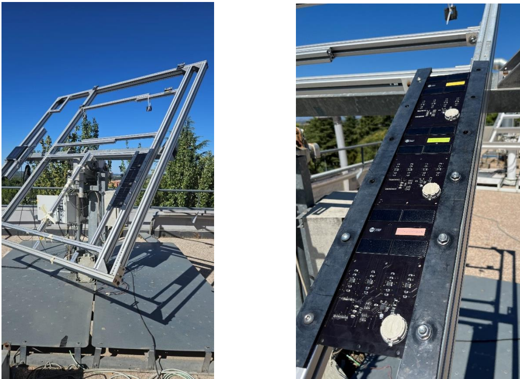
Figura 62. Colocación células en seguidor de doble eje.
