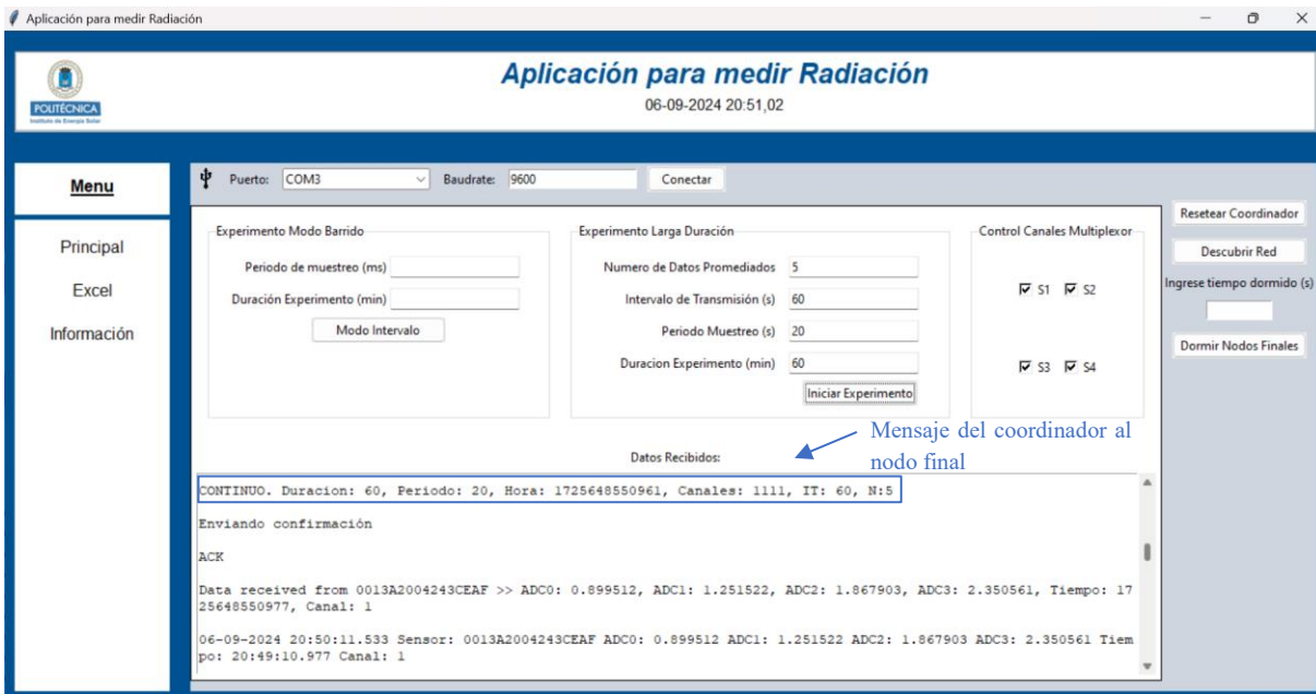
Figura 58. Verificación funcionalidad en modo intervalo.
