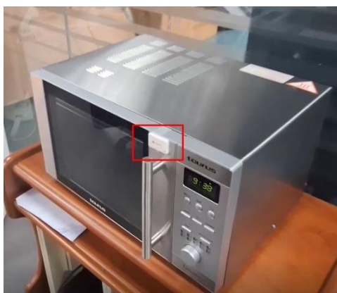
Figura 132. Beacon integrado en microondas
