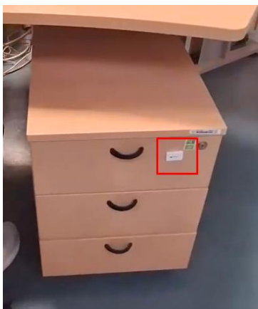
Figura 134. Beacon integrado en cajón
