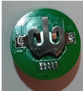
Figura 125. Parte inferior BLE_PCB_V1 con componentes soldados
