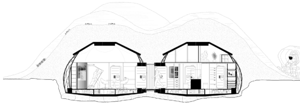
figura 5.18 Sección del Mars Habitat, proyecto desarrollado por Foster + Partners. Imagen recuperada de Archello.
