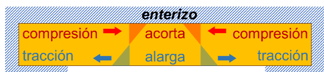
[50] esquema de un dintel trabajando a flexión
