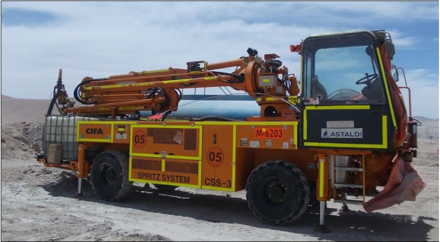
Camión para gunitado.
