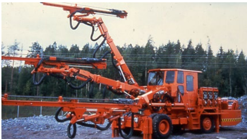
Perforación y voladura (jumbo)
