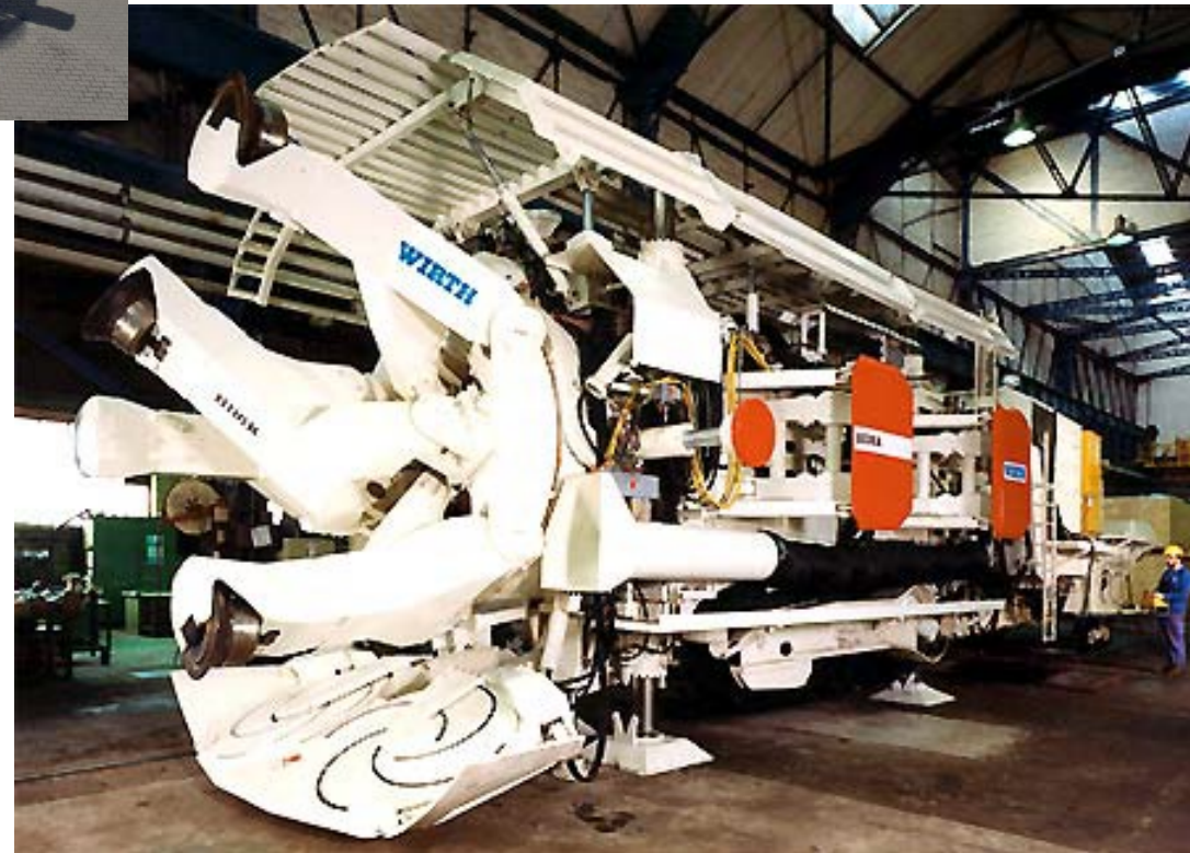
La Mobile Tunnel Miner (MTM) desarrollada para túneles en roca dura.
