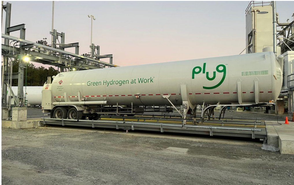
Figura 3-7: Cisterna de hidrógeno líquido [17]
