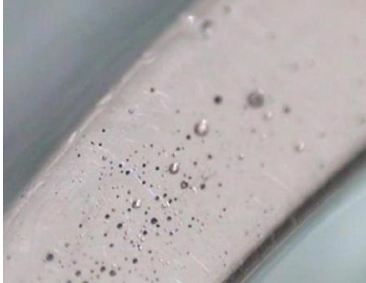
Figura 2-2: Ejemplo de pieza de aluminio con porosidad [7]
