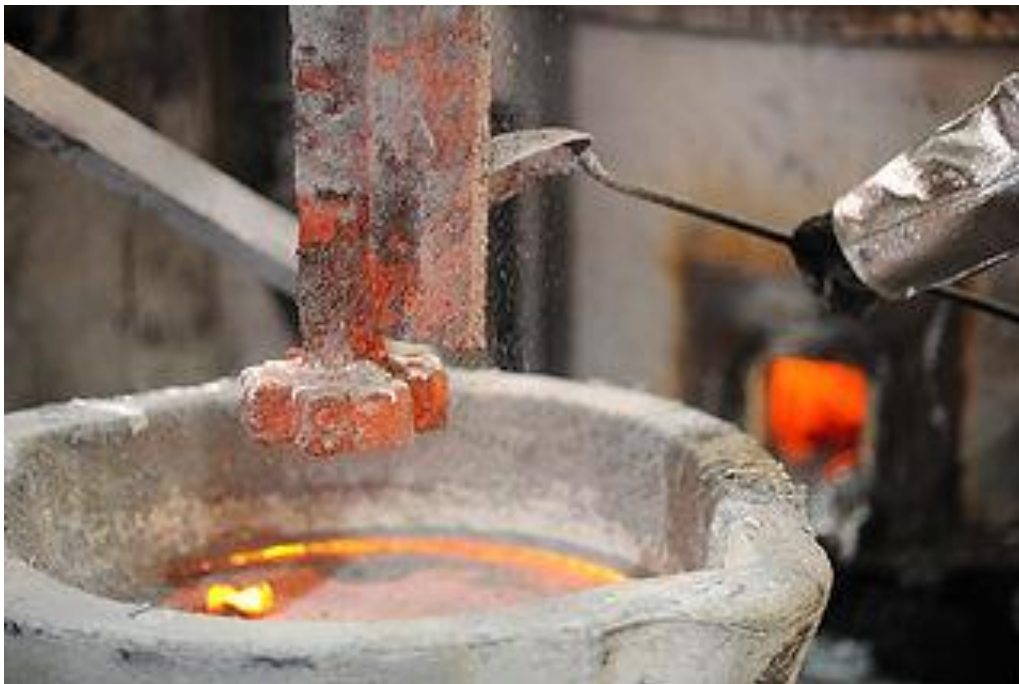
Figura 2-3: Rotor y flecha de grafito para degasificación [8]
