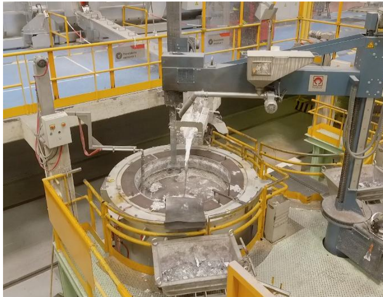
Figura 1-5: Horno crisol de la planta de Bergara [6]
