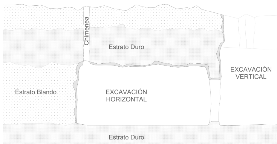
2.7. Detalle de proceso de excavación (Elaboración propia)
