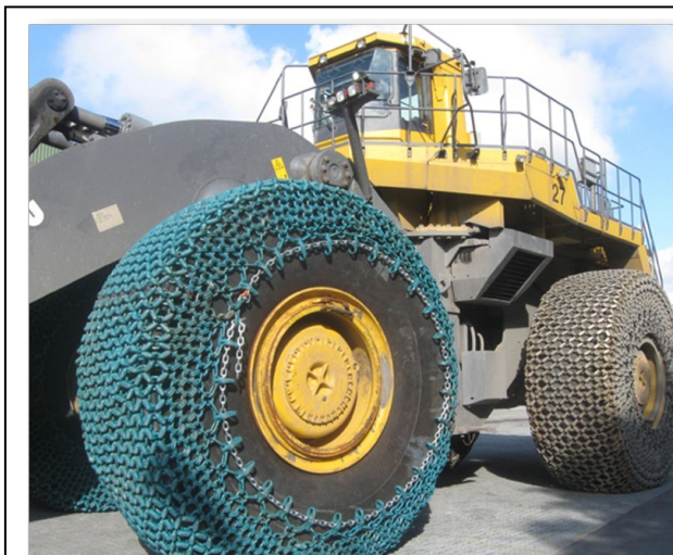
Pala cargadora equipada de sistemas de cadenas para la protección de sus neumáticos
