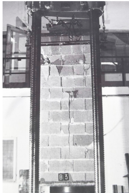
Fig. 2.26 [cat_2 fet.e.1] Ensayo A1 rotura de muro a compresión del sistema Tabibloc
