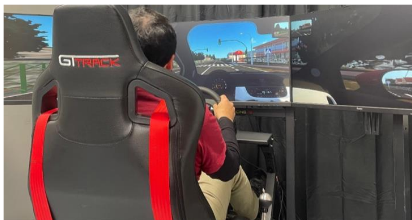
Figure 6. The driving simulator at the Road Laboratory of the Escuela Técnica Superior de Ingenieros de Caminos, Canales y Puertos (Universidad Politécnica de Madrid).
