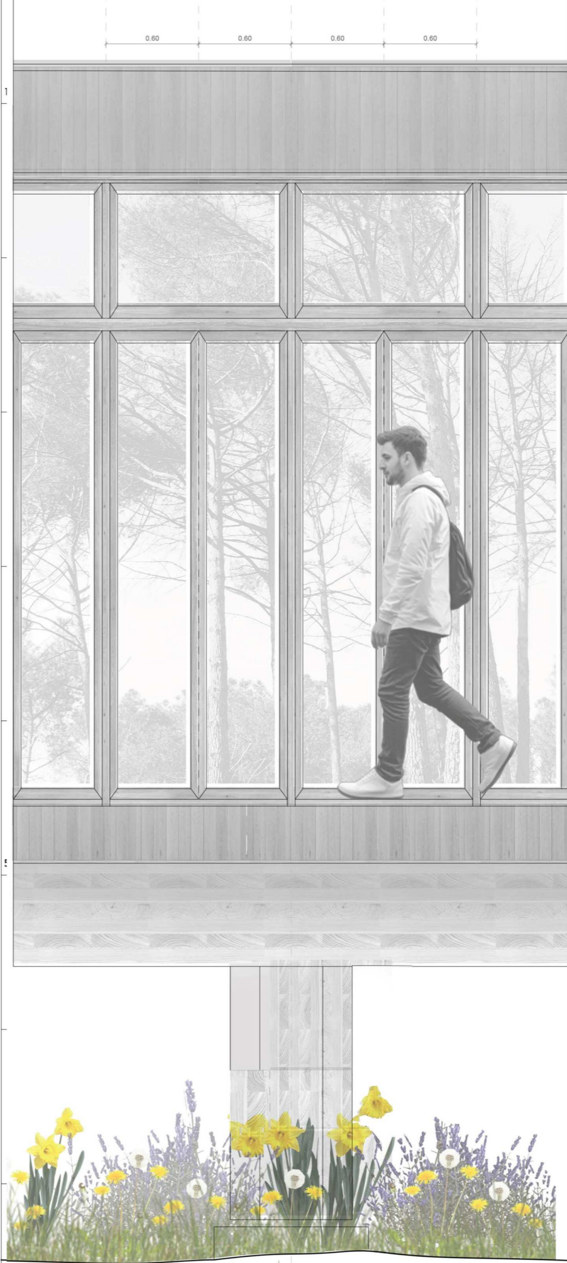
Fachada tipo 2 - ventanales de madera Alzado y sección 1:25
