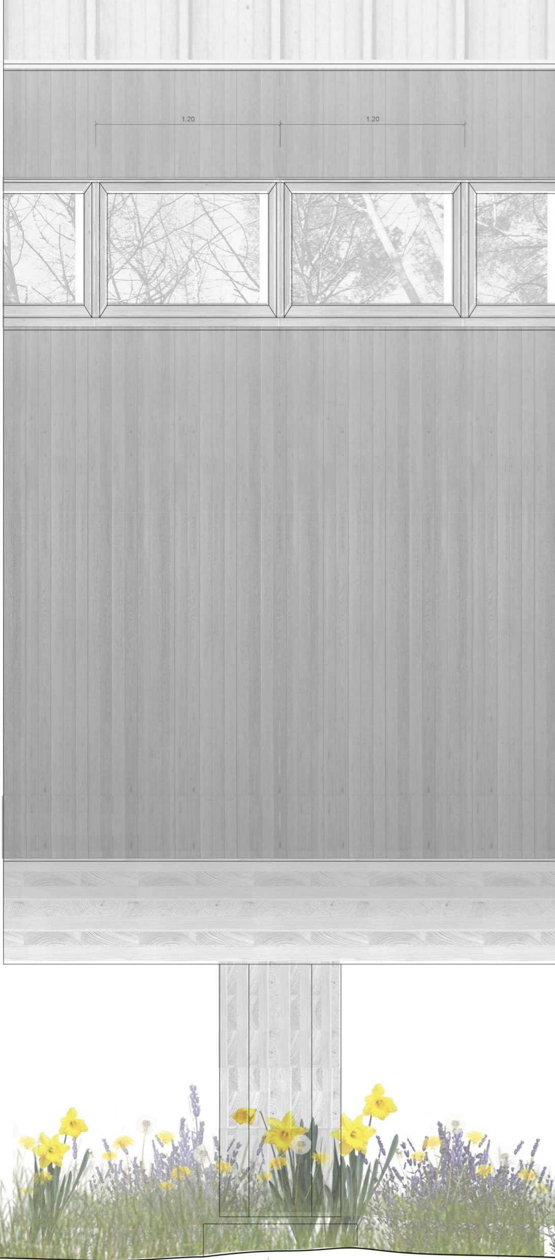
Fachada tipo 1 - fachada ventilada Alzado y sección 1:25
