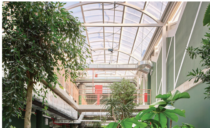
Figura 6.23: Invernadero espacio central plantas superiores con cubierta de policarbonato.
