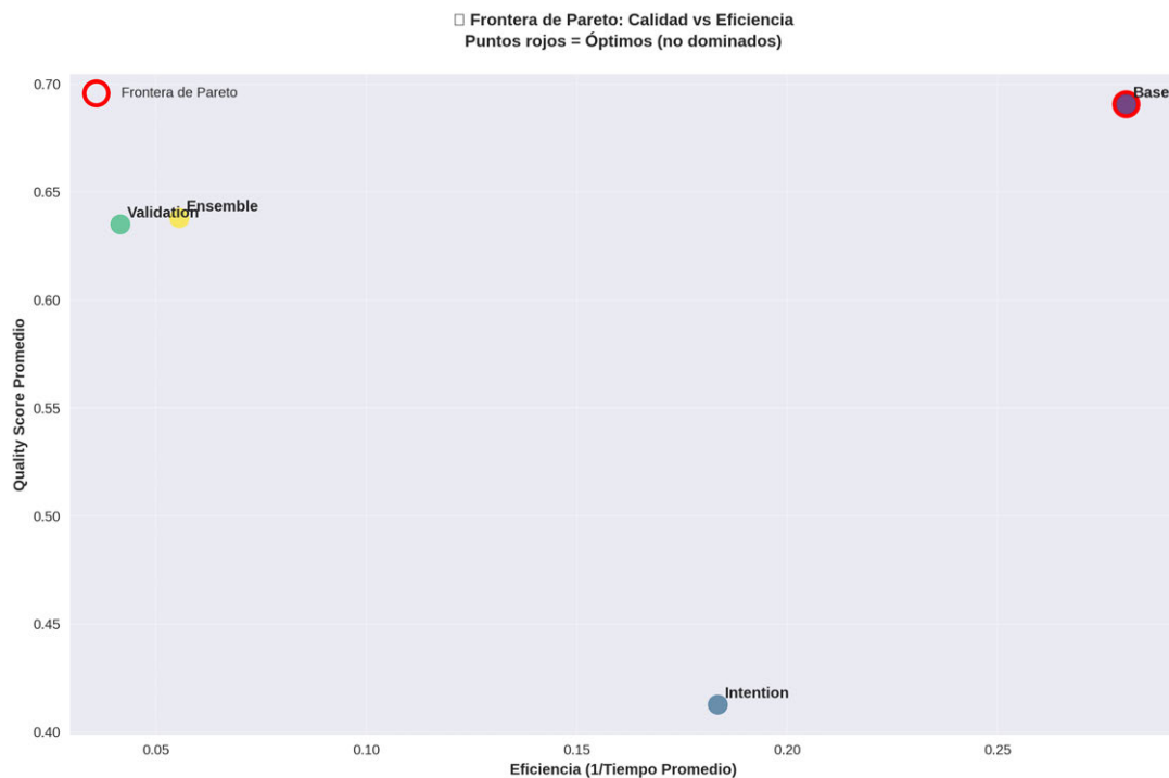
Figura 6.10. Frontera de Pareto que ilustra el compromiso entre la Calidad de los resultados (MRS) y la Eficiencia (inverso de la latencia). Los puntos en la frontera (rojo) representan las soluciones óptimas. El Agente Base es la única arquitectura que se sitúa en esta frontera.
