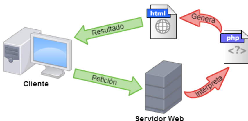
Ilustración 10: Diagrama del funcionamiento de PHP
