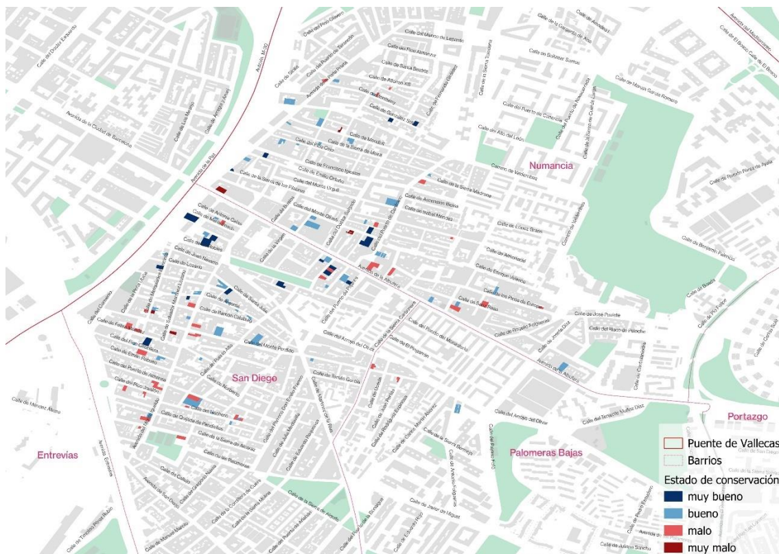
Figura 9: Plano de Puente de Vallecas donde se muestran los edificios de interés según su estado de conservación. Elaboración propia
